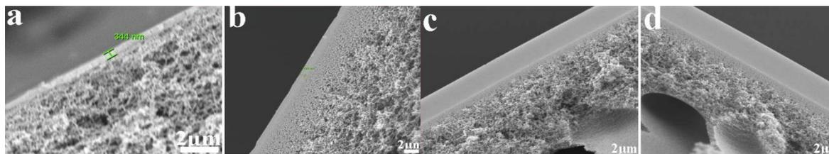
Fig. 7 SEM images of the different concentrations of SPSf; (a) 0.3 wt%; (b) 0.5 wt%; (c) 0.7 wt%; (d) 1 wt%
