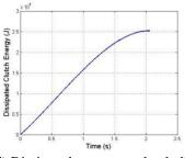
(d) Dissipated energy on clutch disc
