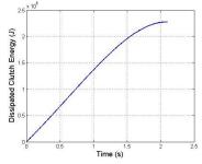
(d) Dissipated energy on clutch disc
