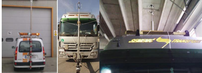
Fig. 4 3-D anemometers (Batista 2011)
