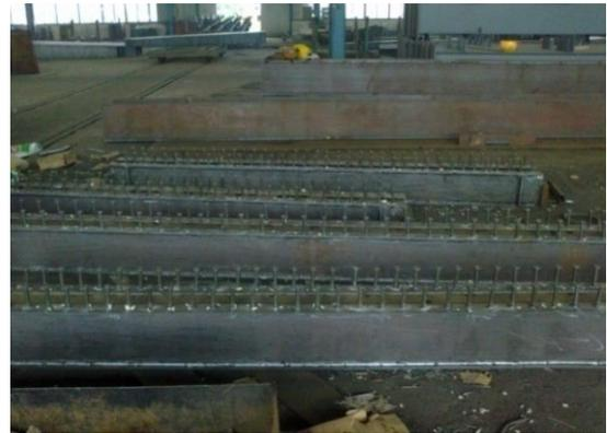
Fig. 2 Welding Studs
