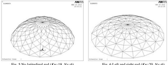
Fig. 5 No latitudinal rod (*Kn*=18, *Nx*=6)
