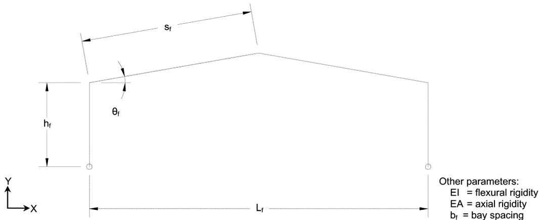
Fig. 1 Portal frame parameters
