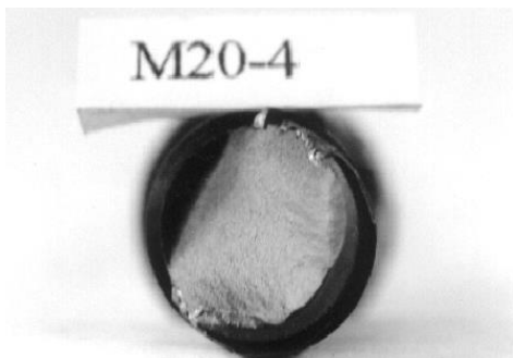
Fig. 11 M20-4 macro-view fracture
