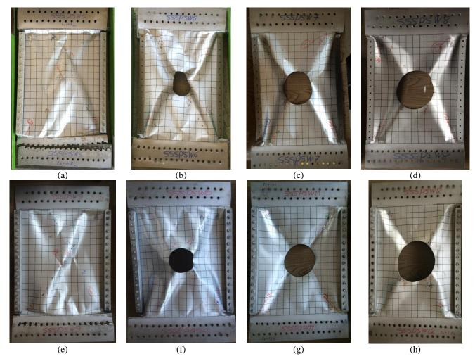
Fig. 7 Failure modes of all the specimens: (a) SSW-BO-1, (b) SSW-BO-2, (c) SSW-BO-3, (d) SSW-BO-4, (e) SSW-BO-5, (f) SSW-BO-6, (g) SSW-BO-7 and (h) SSW-BO-8
