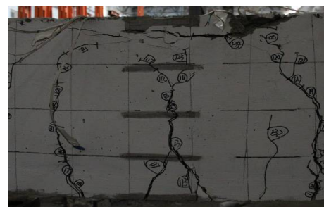
(d) Mid-span crack after unloading
