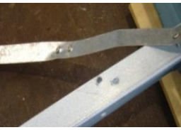
(d) Pulling out of the screws
