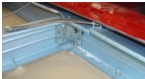
(d) Tearing of the track
