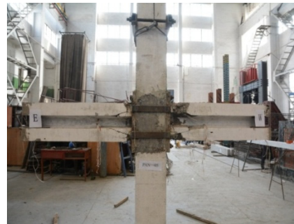
(d) PAN-05 ultimate failure diagram
