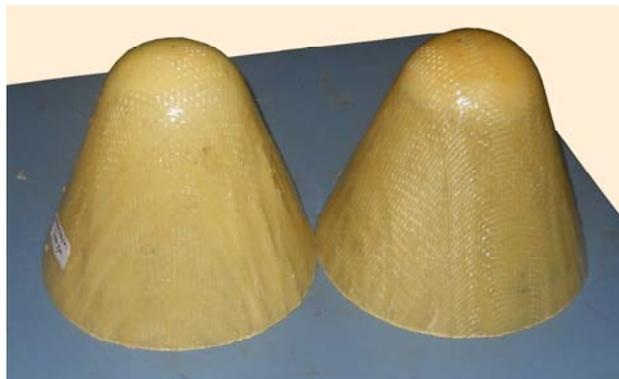
Fig. 7 GFRP shell
