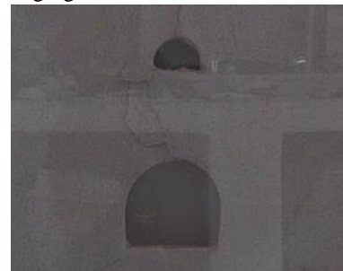
(d) 90° diverging direction at 1.0D inter-tunnel distance
