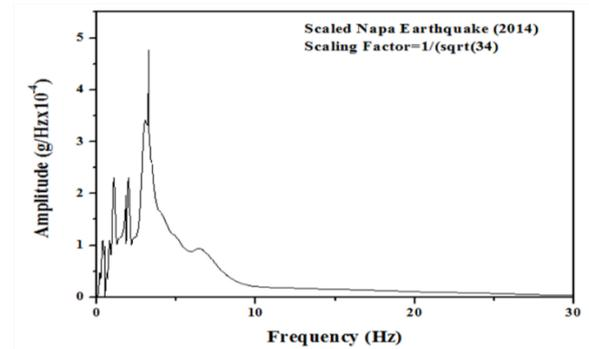
(d) Fourier transform for Napa Earthquake
