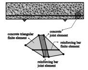
Fig. 3 Discretisation of RC structure
