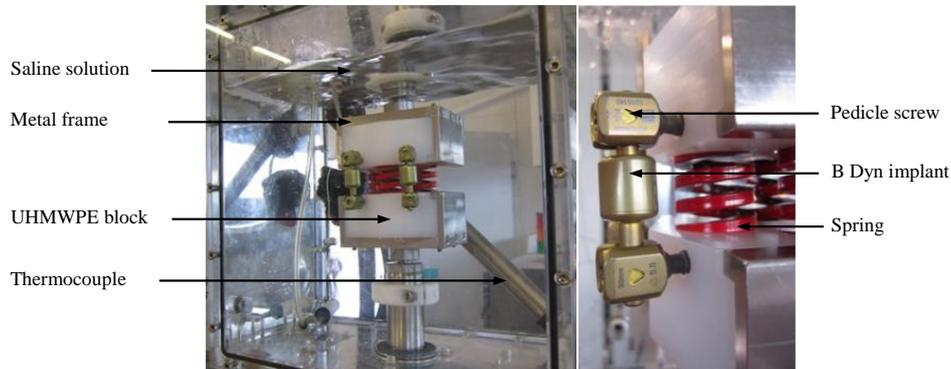
Fig. 2 Fatigue test apparatus
