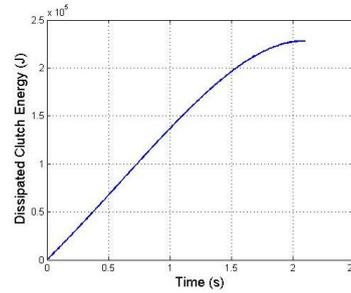
(d) Dissipated energy on clutch disc
