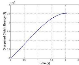
(d) Dissipated energy on clutch disc
