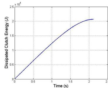
(d) Dissipated energy on clutch disc
